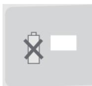
**Errore.** È stato rilevato un guasto di carica della batteria. Il caricabatteria ha rilevato un guasto interno relativo al caricabatteria, se non c'è una batteria nell'alloggiamento di carica.
